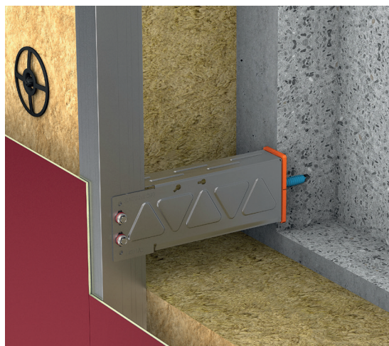
Punkt przesuwny: zamocowanie w otworze owalnym
