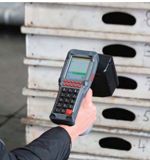
Fot. 6. Czytniki RFID dają możliwość skanowania elementów w promieniu do kilkunastu metrów
