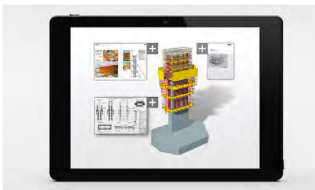
Fot. 5. Dokumentacja technologiczna projektu i systemów deskowań PERI dołączona bezpośrednio do elementów modelu, w jednym miejscu, dzięki technologii BIM
